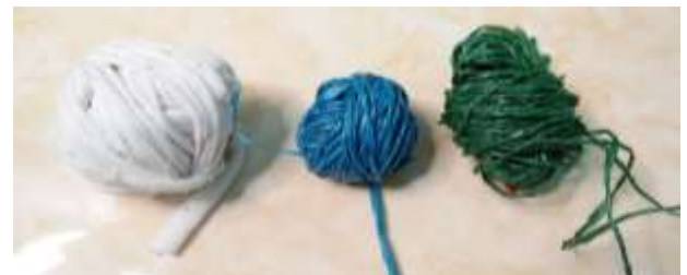
Gambar 5. (Dari kiri ke kanan) Yarn yang terbuat dari material kain, plastik, dan kertas.
